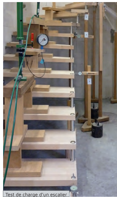
Test de charge d'un escalier
